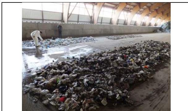
② Analysepool: Auslegung und Trocknung (hinten links: P-Flaschen; hinten rechts: P-Becher; vorne: P-Blister/Schalen)
