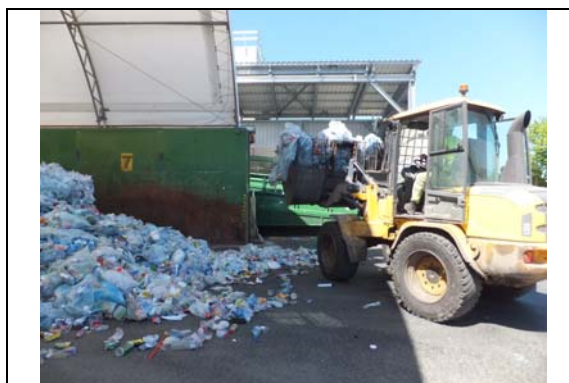
② Zuführung der PMG-Säcke zur Sortierung (hier: Befüllung des Sackaufreißers)
