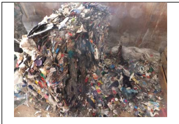
⑤ Pilotphase i. e. S.: Sukzessive Materialdekompaktierung und -entnahme zum Zwecke der Zuführung zur Sortierung
