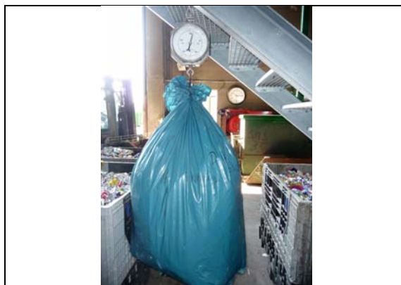
⑧ Datenaufnahme „Sortieroutput“ (hier: Verwiegung von Kleinmengen über die Kranwaage der Fa. Hein Déchets)
