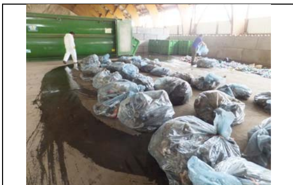
① Analysepool: Entnahme aus einem 30m³-Container und Vorbereitung zur Trocknung
